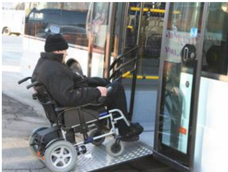
Рисунок 11 Организация посадки в низкопольный автобус инвалида-колясочника
